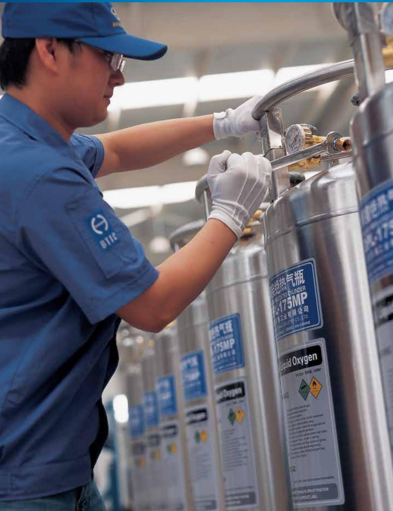
焊接绝热气瓶用于贮存、运输液化空气产品（液氧、液氩、液氮，其中高压瓶还可以充装液态二氧化碳和氧化亚氮介质）的高真空多层绝热可移动式低温液体容器。
